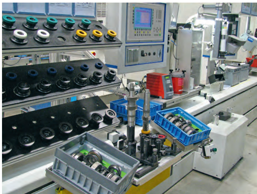
Montage des Getrieberradsatzes. Gut zu erkennen sind die Setkörbe für die mitgeführten Werkstücke.
