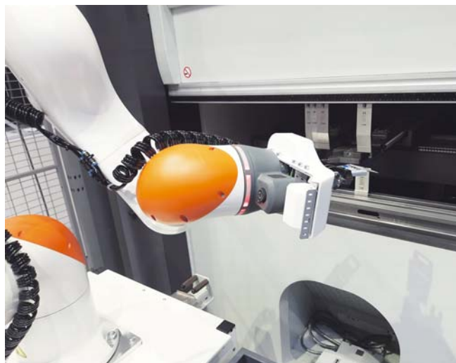
Gewinner des Kuka Innovation Award 2024: Dieser Leichtbauroboter interagiert mit einer Blechbiegemaschine. Er bedient sich dabei aus einem Blechteilelager und ist in die Steuerung der Biegeautomaten eingebunden. Foto: M. Ciupek
